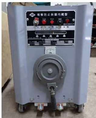
內藏式交流電焊機用 自動電擊防止裝置 TC12000R-001
