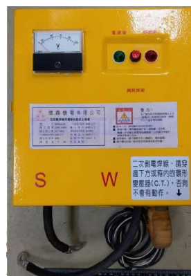
交流電焊機用自 動電擊防止裝置 TC070009-001
