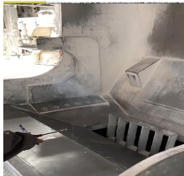
建築漆製程2F E16 COWERS 抽氣擾流狀況
