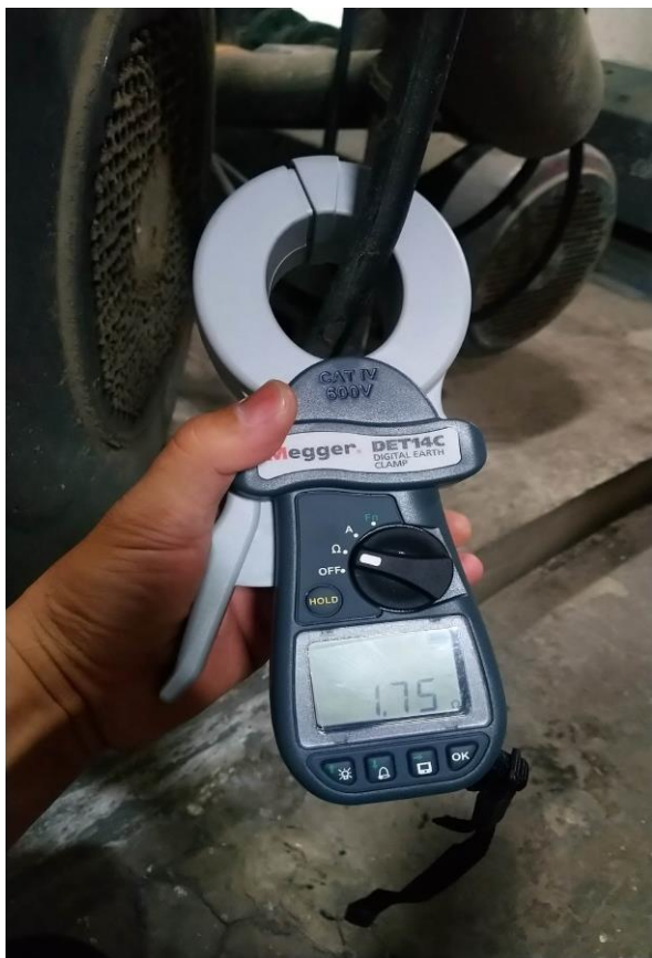
接地電阻量測1.75Ω
