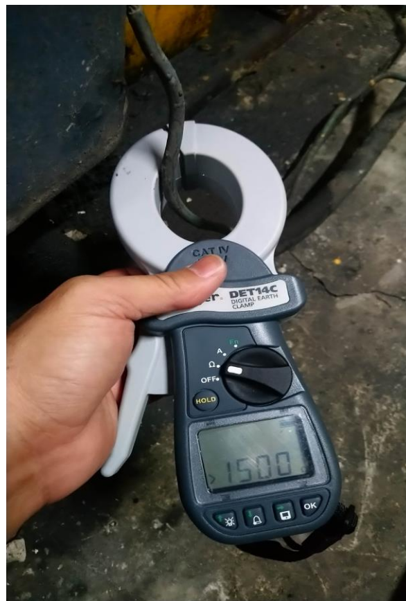
接地電阻量測>1500Ω
