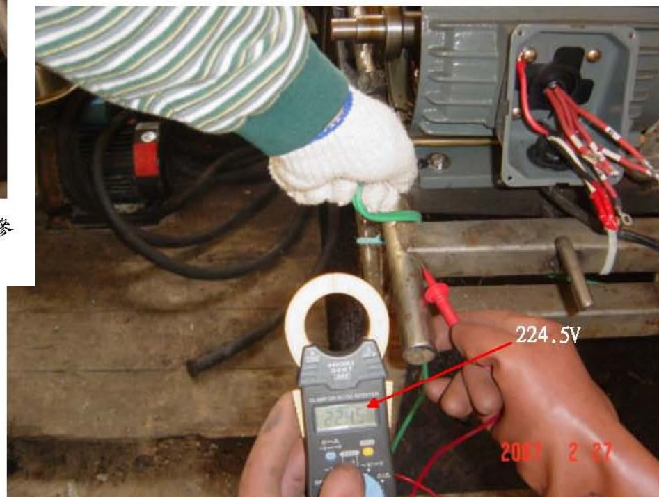
圖 12 馬達外殼有接地時，測量馬達外殼對遠處路燈燈桿（當作參考位準）間之電壓為 224.5V
