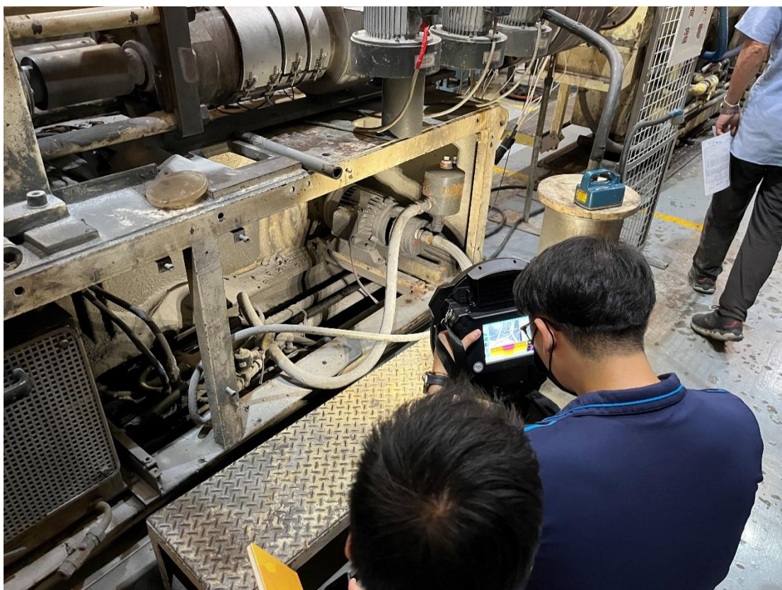
圖 4 進階改善輔導-22AB1009 透過聲學相機辨識押出機之噪音源分布與頻帶
