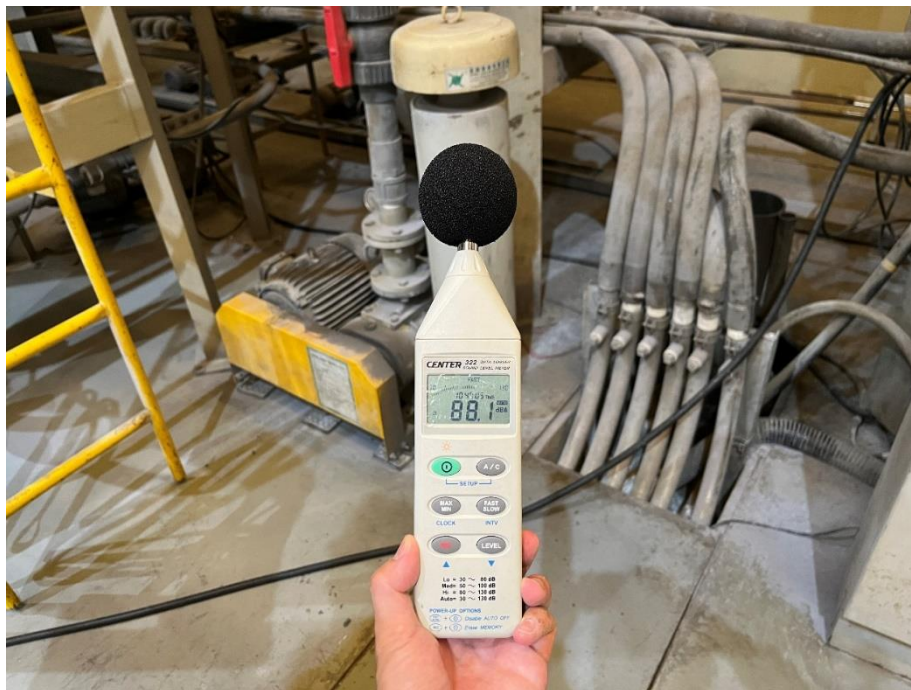
圖 7 進階改善輔導-22AB1009 押出機抽料泵浦作業時之瞬間音壓量測
