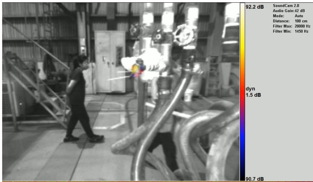
圖 10 進階改善輔導-22AB1009 押出機抽料補氣系統進氣口之瞬間音壓視覺化
