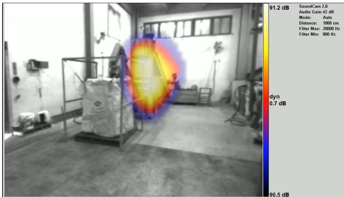
圖 13 進階改善輔導-22AB1009 破碎機運作時之瞬間音壓視覺化
