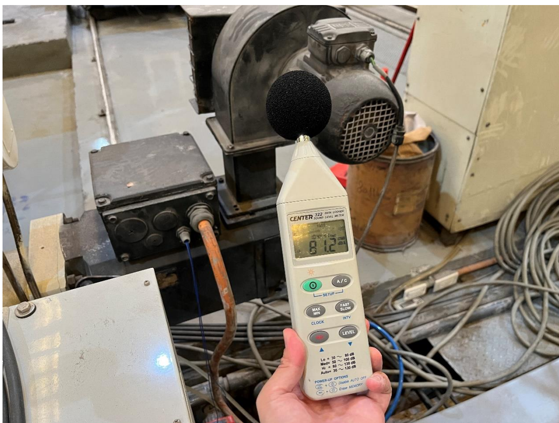
圖 16 進階改善輔導-22AB1009 新設置押出機馬達運轉瞬間音壓量測
