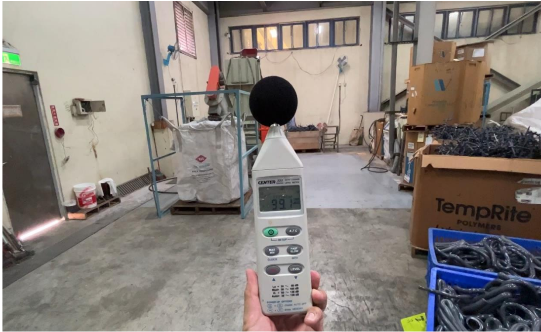
圖 12 進階改善輔導-22AB1009 破碎機運作時之瞬間音壓量測
