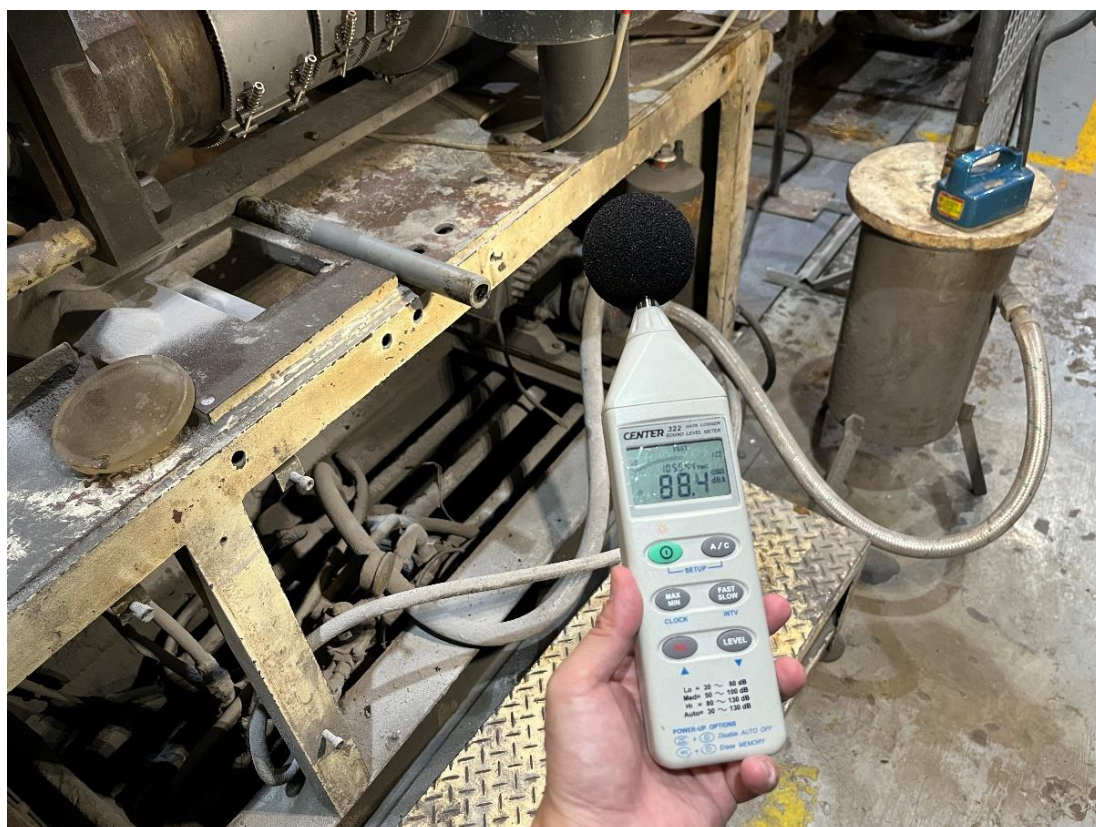
圖 1 進階改善輔導-22AB1009 押出機作業時馬達運轉之瞬間音壓量測
