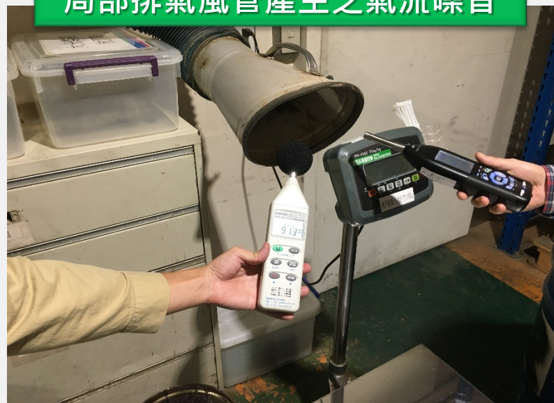
局部排氣風管產生之氣流噪音
