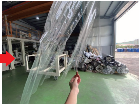
負壓風扇開啟後補氣明顯
