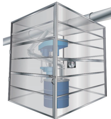
建議增加攪拌隔間並將攪拌桶上蓋及增加抽氣裝置
