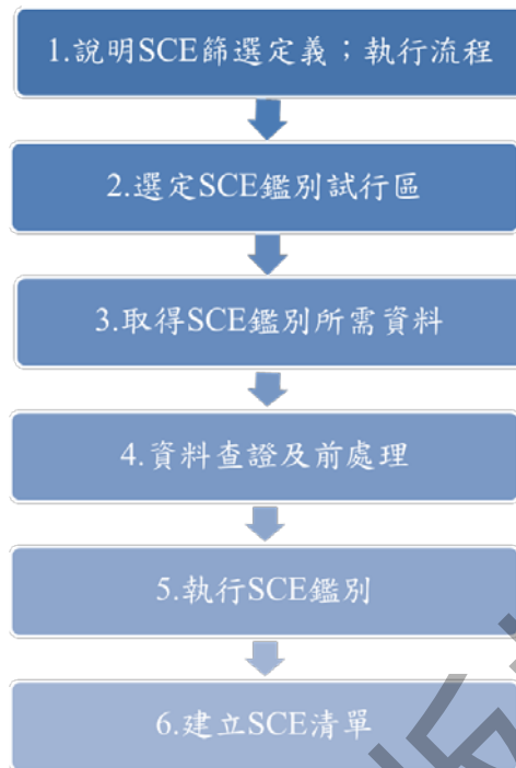
圖 1、本計畫執行 SCE 鑑別作業流程
