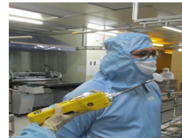
PID使用注意事項 採樣時直讀式儀器須置於人員呼吸帶周圍
