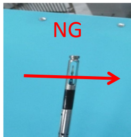
風速計使用注意事項 採樣時，氣流須通過採樣頭
